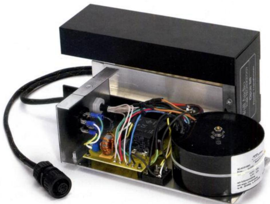
Der für Wall Audio gefertigte Trafo befindet sich in einem doppelt geschirmten, externen Gehäuse, das stattliche 6 kg auf die Waage bringt
