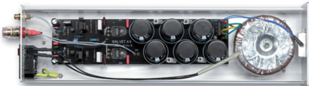
Der Monoblock: Klein, fein, kompakt und sprichwörtlich heißblütig. Zum Einsatz kommen lediglich insgesamt acht Transistoren
